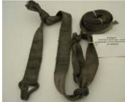
Abb. 22: Verlängerung durch Knoten
